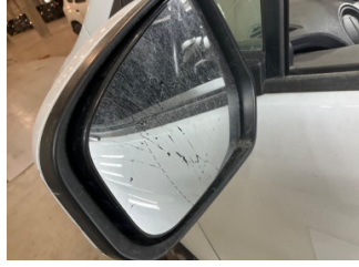
Dikiz aynası, sol, Dış dikiz aynası > Hasarlı
