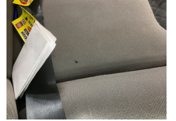
Döşemeler/Kapaklar, Döşemeler/Kapaklar > Yakıcı Madde ile Zarar Görmüş
