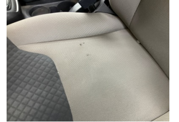
Döşemeler/Kapaklar, Döşemeler/Kapaklar > Yakıcı Madde Ile Zarar Görmüş
