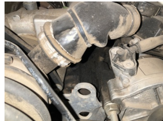
Motor, Motor > Yağ Kaçağı
