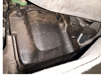
Motor, Motor > Yağ Kaçağı
