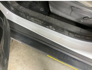
Marşbiyel, sol, Marşbiyel, sol > Boyası Atmış
