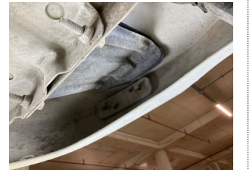
Tampon, arka, Bağlantı ayağı > Hasarlı
