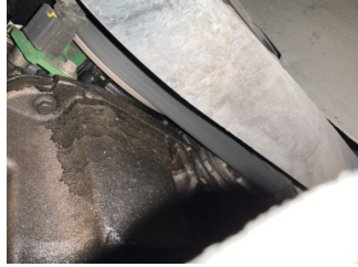
Motor, Motor > Yağ Kaçağı
