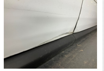
Kapı, sağ arka, Kapı, sağ arka > Ezik
