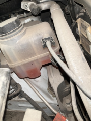
Motorsoğutması, Soğutma sıvısı > Eksik
