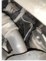
Motor, Motor > Yağ Kaçağı
