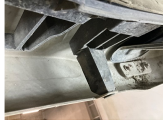
Tampon, arka, Bağlantı ayağı > Hasarlı
