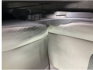
Döşemeler/Kapaklar, Döşemeler/Kapaklar > Deforme Olmuş
