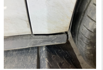
Marşbiyel, sağ, Marşbiyel plastiği, sağ > Sabitlemesi Hatalı
