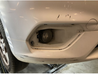
Sis lambaları, Sis Izgarası Sağ > Sökülmüş-Yok
