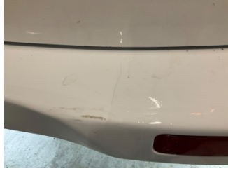
Tampon, arka, Arka tampon > Boyası Atmış
