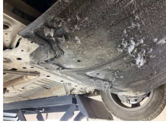
Motor, Alt muhafaza > Hasarlı
