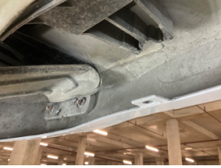
Tampon, arka, Bağlantı ayağı > Hasarlı
