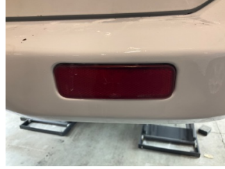
Tampon, arka, Reflektör, sağ > Çatlak
