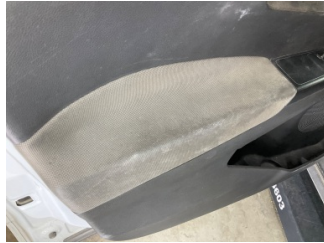
Döşemeler/Kapaklar, Döşemeler/Kapaklar > Yakıcı Madde Ile Zarar Görmüş
