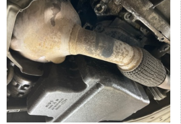
Motor, Motor > Yağ Kaçağı
