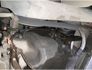
Motor, Motor > Yağ Kaçağı
