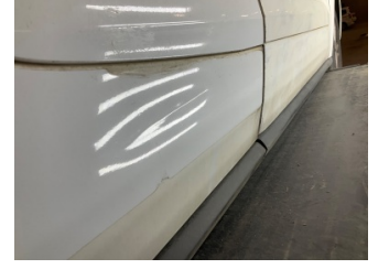
Kapı, sağ arka, Kapı, sağ arka > Ezik
