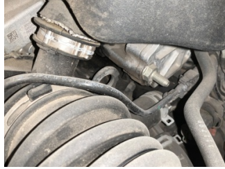
Motor, Motor > Yağ Kaçağı
