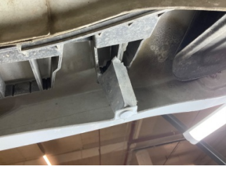
Tampon, arka, Bağlantı ayağı > Hasarlı
