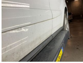
Kapı, sol ön, Kapı, sol ön > Ezik
