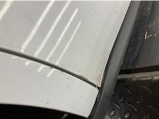
Kapı, sağ arka, Kapı, sağ arka > Çizik
