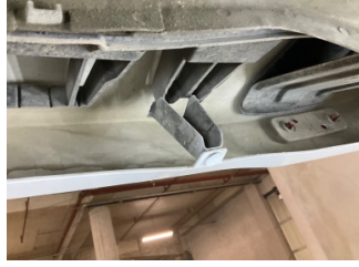
Tampon, arka, Bağlantı ayağı > Hasarlı
