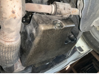
Motor, Motor > Yağ Kaçağı
