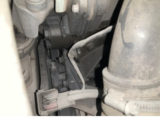
Motor, Motor > Yağ Kaçağı
