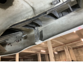
Tampon, arka, Bağlantı ayağı > Hasarlı
