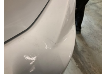
Tampon, arka, Arka tampon > Boyası Atmış
