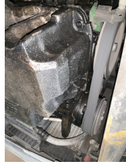
Motor, Motor > Yağ Kaçağı
