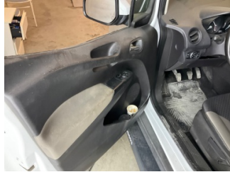
Döşemeler/Kapaklar, Döşemeler/Kapaklar > Deforme Olmuş
