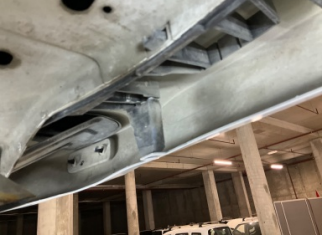
Tampon, arka, Bağlantı ayağı > Hasarlı
