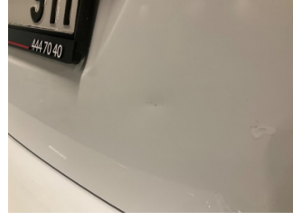
Bagaj kapağı/kapısı, Bagaj kapısı > Ezik
