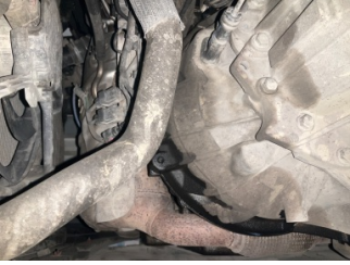
Şanzıman, Şanzıman > Yağ Kaçağı
