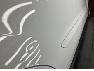
Kapı, sağ arka, Kapı, sağ arka > Ezik
