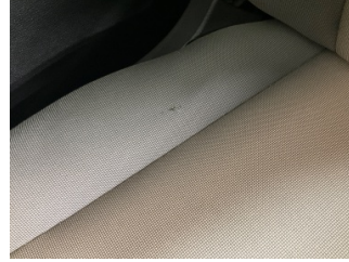
Döşemeler/Kapaklar, Döşemeler/Kapaklar > Yakıcı Madde ile Zarar Görmüş
