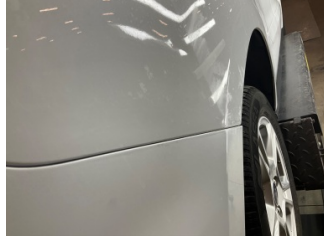
Çamurluk, sağ arka, Çamurluk, sağ arka > Ezik
