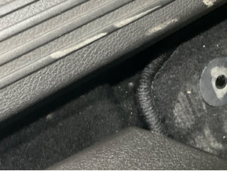
Döşemeler/Kapaklar, Döşemeler/Kapaklar > Yakıcı Madde ile Zarar Görmüş
