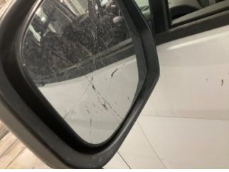
Dikiz aynası, sol, Ayna camı > Hasarlı
