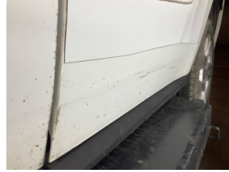
Kapı, sol arka, Kapı, sol arka > Çizik
