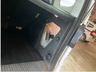
Döşemeler/Kapaklar, Döşemeler/Kapaklar > Sökülmüş-Yok
