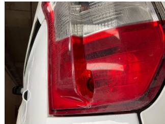
Arka lambalar, Arka lamba camı, sol > Hasarlı
