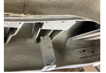
Tampon, arka, Bağlantı ayağı > Hasarlı
