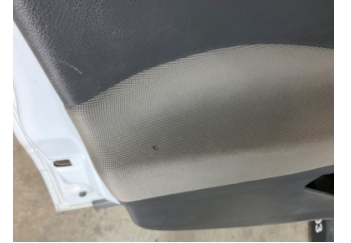
Döşemeler/Kapaklar, Döşemeler/Kapaklar > Yakıcı Madde Ile Zarar Görmüş
