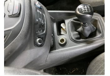
Elektrik donanımı/Pano, Çakmak > Sökülmüş-Yok
