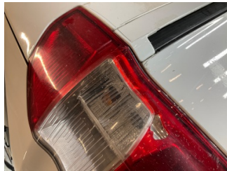
Arka lambalar, Arka lamba camı, sağ > Hasarlı
