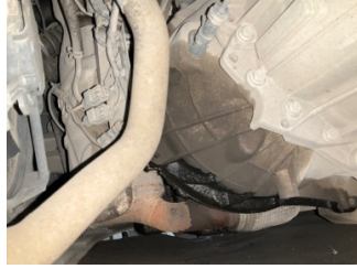
Şanzıman, Şanzıman > Yağ Kaçağı
