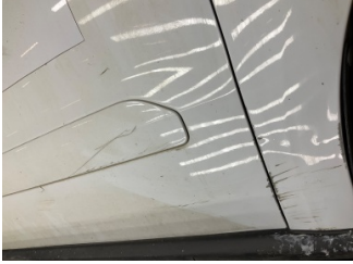
Kapı, sağ ön, Kapı, sağ ön > Çizik
