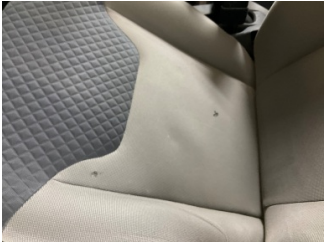
Döşemeler/Kapaklar, Döşemeler/Kapaklar > Yakıcı Madde Ile Zarar Görmüş
