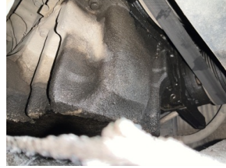
Motor, Motor > Yağ Kaçağı
