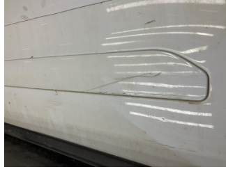
Kapı, sağ ön, Kapı bandı > Çizik
