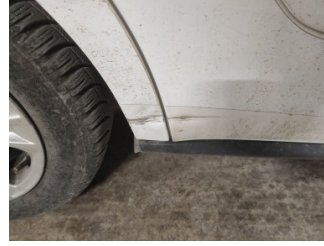
Çamurluk, sağ arka, Çamurluk, sağ arka > Ezik
