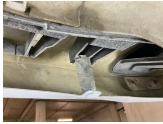
Tampon, arka, Bağlantı ayağı > Hasarlı
