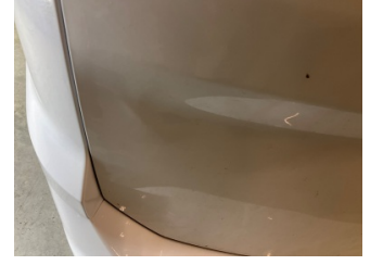
Bagaj kapağı/kapısı, Bagaj kapısı > Ezik
