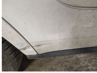
Kapı, sağ arka, Kapı, sağ arka > Ezik
