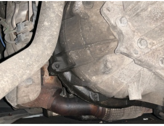
Şanzıman, Şanzıman > Yağ Kaçağı
