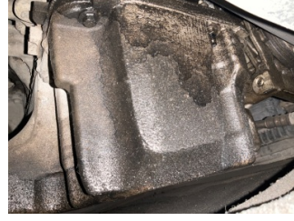
Motor, Motor > Yağ Kaçağı
