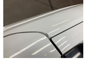
Kaporta, Sağ Üst Frangart > Boyası Atmış
