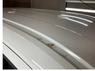
Tavan, Tavan > Dolu Hasarı
