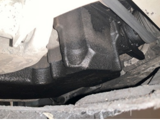
Motor, Motor > Yağ Kaçağı
