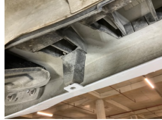
Tampon, arka, Bağlantı ayağı > Hasarlı
