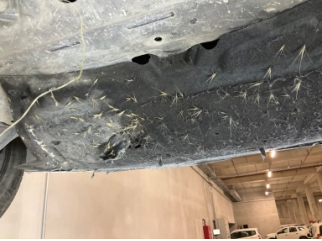
Motor, Alt muhafaza > Hasarlı
