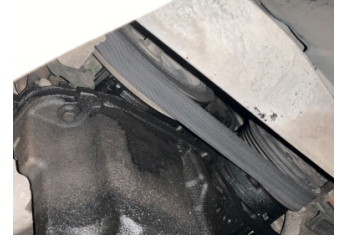
Motor, Motor > Yağ Kaçağı
