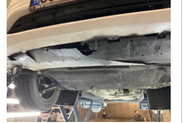
Tampon, ön, Tampon koruyucu orta > Hasarlı
