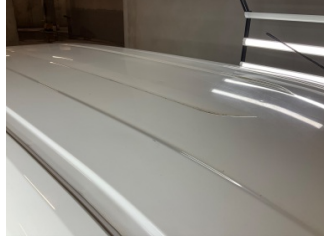
Tavan, Tavan > Dolu Hasarı
