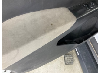
Döşemeler/Kapaklar, Döşemeler/Kapaklar > Yakıcı Madde Ile Zarar Görmüş
