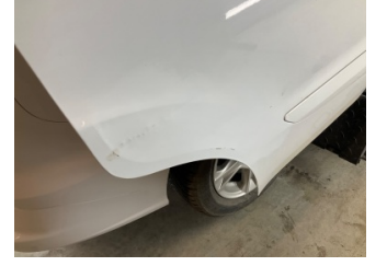
Kapı, sağ arka, Kapı, sağ arka > Hasarlı
