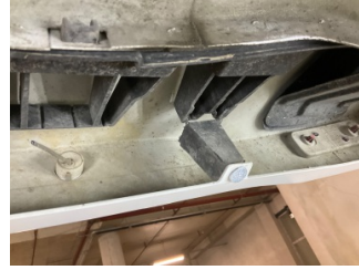
Tampon, arka, Bağlantı ayağı > Hasarlı
