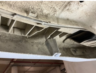
Tampon, arka, Bağlantı ayağı > Kırılmış
