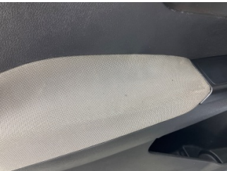
Döşemeler/Kapaklar, Kapı döşemesi, sol ön > Yanık Deliği
