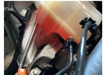
Motorsöğütması, Soğutma sıvısı > Eksik
