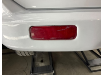
Tampon, arka, Reflektör, sol > Çatlak
