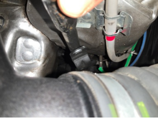
Motor, Yağ kontrol cubuğu > Sabitlemesi Hatalı
