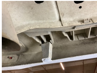
Tampon, arka, Bağlantı ayağı > Kırılmış
