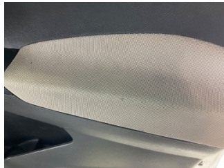
Döşemeler/Kapaklar, Kapı döşemesi, sağ ön > Yanık Deliği
