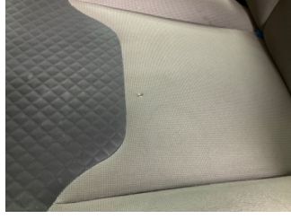
Döşemeler/Kapaklar, Döşemeler/Kapaklar > Yakıcı Madde Ile Zarar Görmüş
