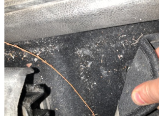
Döşemeler/Kapaklar, Döşemeler/Kapaklar > Yakıcı Madde Ile Zarar Görmüş
