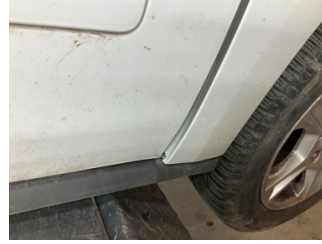
Çamurluk, sağ, Çamurluk, sağ > Sabitlemesi Hatalı
