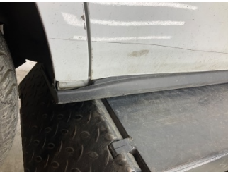
Marşbiyel, sağ, Marşbiyel, sağ > Sabitlemesi Hatalı
