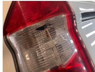
Arka lambalar, Arka lamba camı, sağ > Hasarlı
