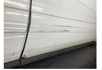
Kapı, sağ ön, Kapı, sağ ön > Hasarlı
