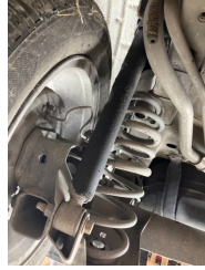
Arka aks, Amortisör, arka sol > Yağ Kaçağı
