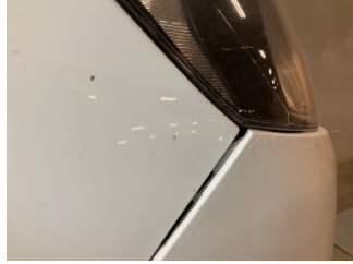
Tampon, ön, Ön tampon > Sabitlemesi Hatalı
