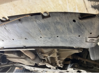
Tampon, ön, Tampon koruyucu orta > Hasarlı
