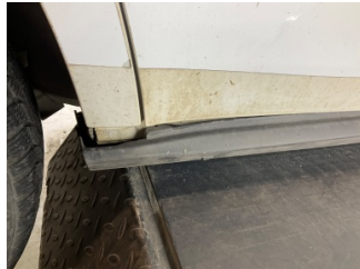
Marşbiyel, sağ, Marşbiyel plastığı, sağ > Hasarlı
