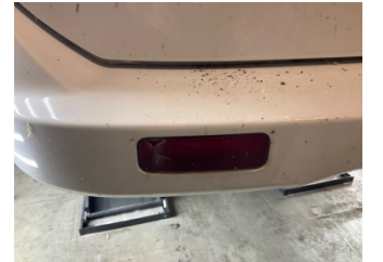
Tampon, arka, Reflektör, sol > Hasarlı
