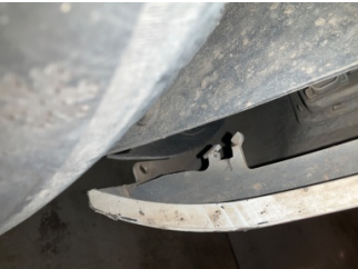
Tampon, ön, Bağlantı ayağı > Kırılmış
