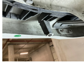
Tampon, arka, Bağlantı ayağı > Hasarlı
