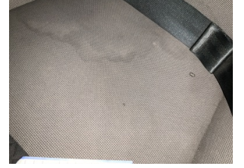
Döşemeler/Kapaklar, Döşemeler/Kapaklar > Yakıcı Madde ile Zarar Görmüş
