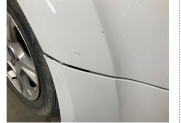
Tampon, ön, Ön tampon > Sabitlemesi Hatalı
