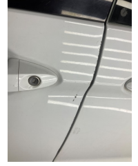
Kapı, sol ön, Kapı, sol ön > Çizik
