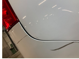
Tampon, arka, Arka tampon > Sabitlemesi Hatalı
