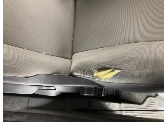
Döşemeler/Kapaklar, Döşemeler/Kapaklar > Hasarlı
