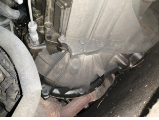
Şanzıman, Şanzıman > Yağ Kaçağı
