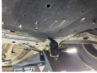
Motor, Alt muhafaza > Hasarlı
