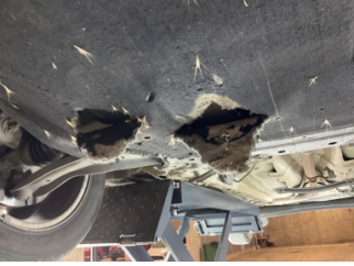
Motor, Alt muhafaza > Hasarlı
