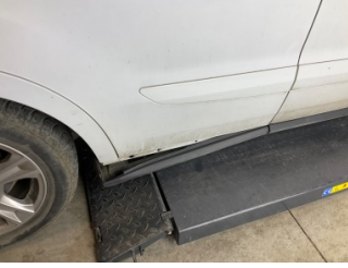
Marşbiyel, sağ, Marşbiyel plastiği, sağ > Hasarlı
