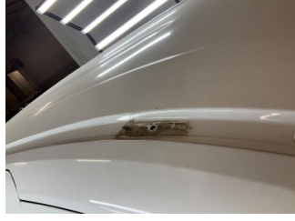
Tavan, Rüzgar engelleyici > Sökülmüş-Yok
