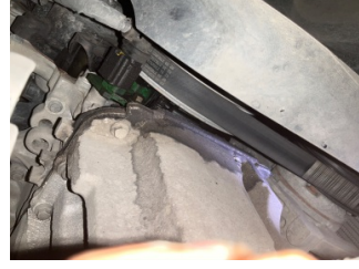
Motor, Motor > Yağ Kaçağı
