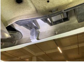
Tampon, arka, Bağlantı ayağı > Hasarlı
