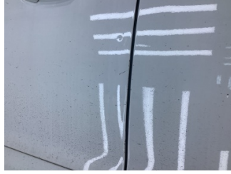
Kapı, sol ön, Kapı, sol > Ezik
