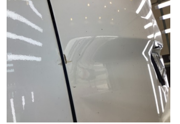
Bagaj kapađı/kapısı, Bagaj kapısı > Çizik
