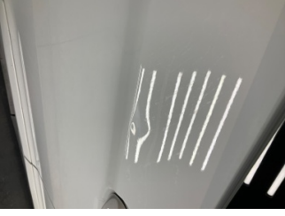
Kapı, sağ arka, Kapı, sağ arka > Ezik
