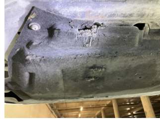
Motor, Alt muhafaza > Hasarlı
