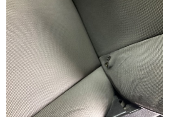
Koltuklar, ön, Koltuk arkılığı döşemesi, sol ön > Hasarlı
