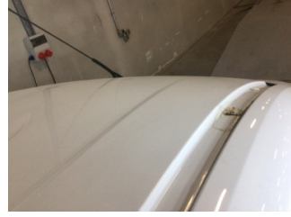
Tavan, Rüzgar engelleyici > Sökülmüş-Yok
