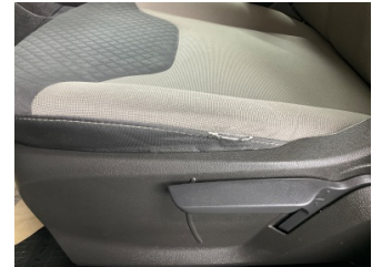
Döşemeler/Kapaklar, Döşemeler/Kapaklar > Deforme Olmuş
