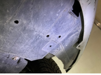
Tampon, ön, Tampon koruyucu orta > Hasarlı
