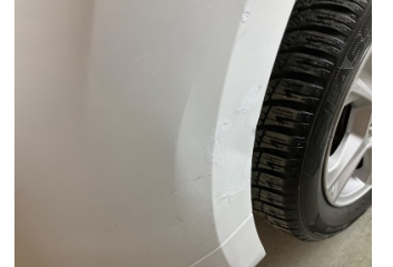
Tampon, ön, Ön tampon > Çatlak
