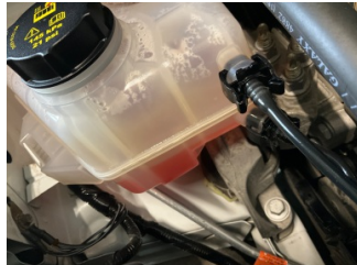
Motorsoğutması, Soğutma sıvısı > Eksik
