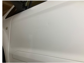
Kapı, sol ön, Kapı, sol ön > Ezik
