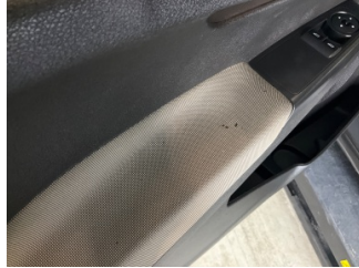
Döşemeler/Kapaklar, Döşemeler/Kapaklar > Yakıcı Madde ile Zarar Görmüş
