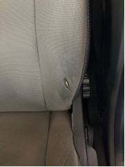
Koltuklar, ön, Koltuk döşemesi, sol ön > Hasarlı
