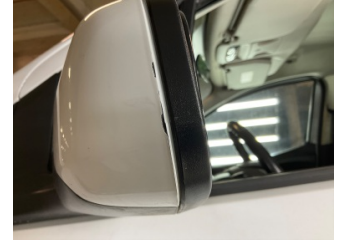
Dikiz aynası, sol, Dış dikiz aynası kapağı > Çizik
