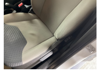
Döşemeler/Kapaklar, Döşemeler/Kapaklar > Deforme Olmuş
