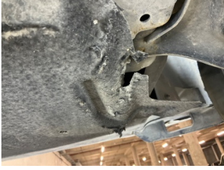
Motor, Alt muhafaza > Hasarlı
