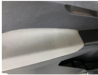
Döşemeler/Kapaklar, Döşemeler/Kapaklar > Yakıcı Madde Ile Zarar Görmüş
