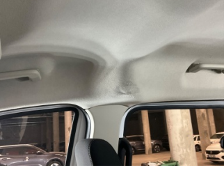
Döşemeler/Kapaklar, Tavan döşemesi > Hasarlı
