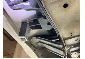
Tampon, arka, Bağlantı ayağı > Hasarlı
