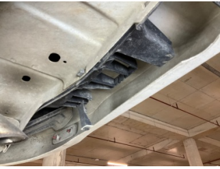
Tampon, arka, Bağlantı ayağı > Hasarlı
