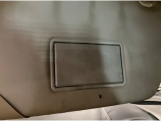
Döşemeler/Kapaklar, Döşemeler/Kapaklar > Deforme Olmuş
