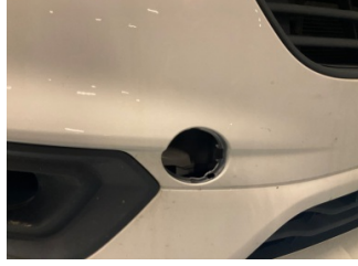
Tampon, ön, Çeki demir kapağı > Sökülmüş-Yok
