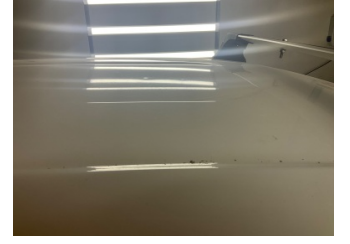
Tavan, Tavan > Dolu Hasarı
