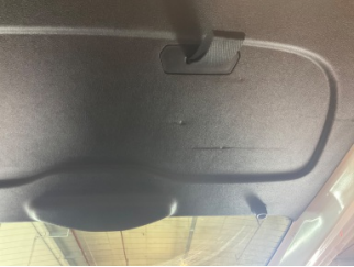
Döşemeler/Kapaklar, Döşemeler/Kapaklar > Çizik
