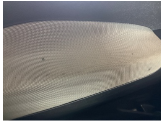
Döşemeler/Kapaklar, Döşemeler/Kapaklar > Yakıcı Madde ile Zarar Görmüş
