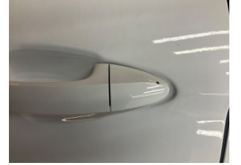
Kapı, sağ arka, Kapı kolu, dış > Çizik
