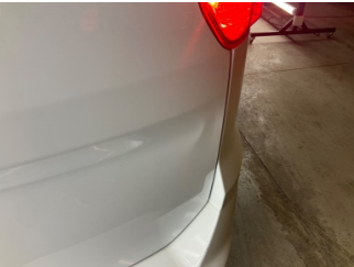
Bagaj kapağı/kapısı, Bagaj kapısı > Ezik
