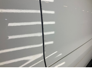
Kapı, sağ ön, Kapı, sağ ön > Çizik
