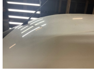
Tavan, Tavan > Dolu Hasarı
