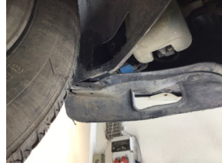
Motor, Alt muhafaza > Hasarlı
