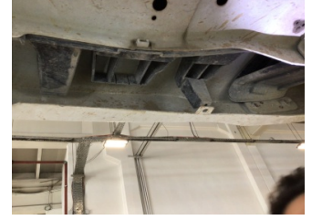
Tampon, arka, Bağlantı ayağı > Hasarlı
