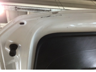
Bagaj kapağı/kapısı, Bagaj kapısı > Ezik
