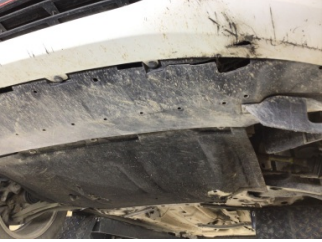
Motor, Alt muhafaza > Hasarlı
