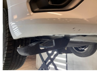
Tampon, ön, Spoiler > Hasarlı
