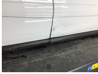
Kapı, sağ arka, Kapı, sağ arka > Çizik
