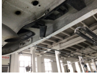
Tampon, arka, Bağlantı ayağı > Hasarlı
