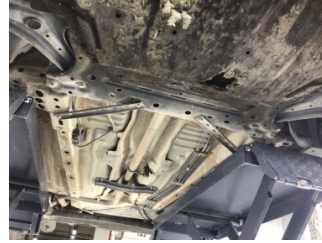
Motor, Alt muhafaza > Hasarlı
