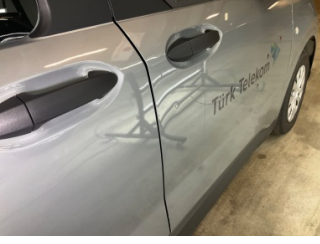
Kapı, sağ ön, Kapı, sağ ön > Vuruk
