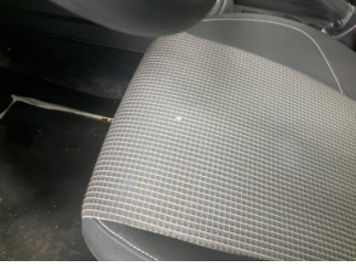
Koltuklar, ön, Koltuk döşemesi, sol ön > Yakıcı Madde Ile Zarar Görmüş
