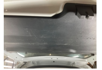
Döşemeler/Kapaklar, Döşemeler/Kapaklar > Deforme Olmuş
