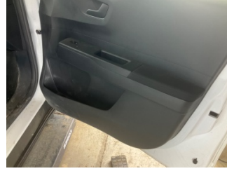
Döşemeler/Kapaklar, Döşemeler/Kapaklar > Deforme Olmuş
