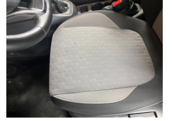
Döşemeler/Kapaklar, Döşemeler/Kapaklar > Yakıcı Madde Ile Zarar Görmüş
