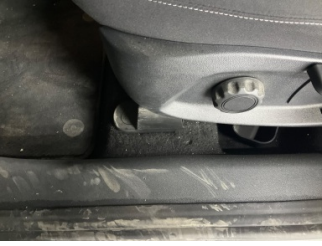
Döşemeler/Kapaklar, Döşemeler/Kapaklar > Yakıcı Madde Ile Zarar Görmüş
