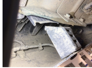
Tampon, arka, Bağlantı ayağı > Hasarlı
