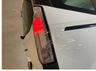
Arka lambalar, Arka lambalar, sağ > Hasarlı
