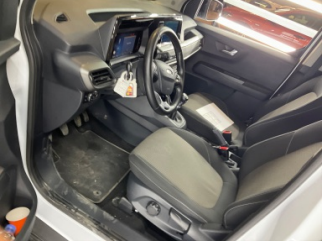
Döşemeler/Kapaklar, Döşemeler/Kapaklar > Kirlenmiş
