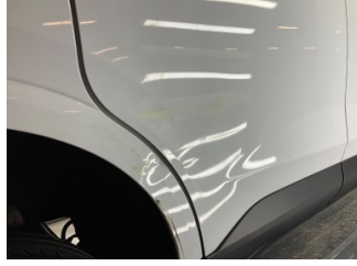
Kapı, sağ arka, Kapı, sağ arka > Hasarlı
