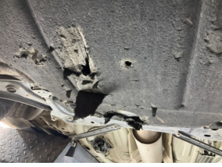
Motor, Alt muhafaza > Hasarlı
